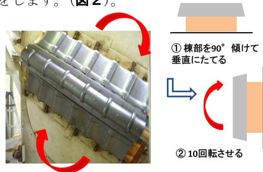
図2 耐震性能試験
