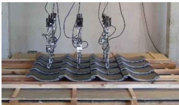
図1 平部の耐風圧試験
